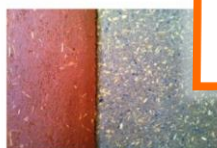
Intégration de sciure de bois, paille hachée, balles de céréales (photo)... dans des enduits terre (qq. fois chaux et/ou plâtre)
