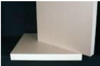
Panneaux de polyisocyanurate (PIR). Famille des PUR
