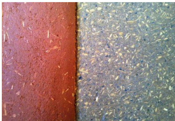
Intégration de sciure de bois, paille hachée, balles de céréales (photo)... dans des enduits terre (qq. fois chaux et/ou plâtre)
