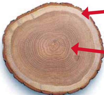
**L'aubier** est la partie du bois la plus récente, la plus éloignée du centre du tronc. En général, il n'est pas naturellement durable et nécessite un traitement pour être mis en oeuvre dans la construction
